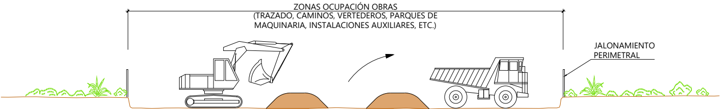
2-RETIRADA SELECTIVA DE LA CAPA EDÁFICA
